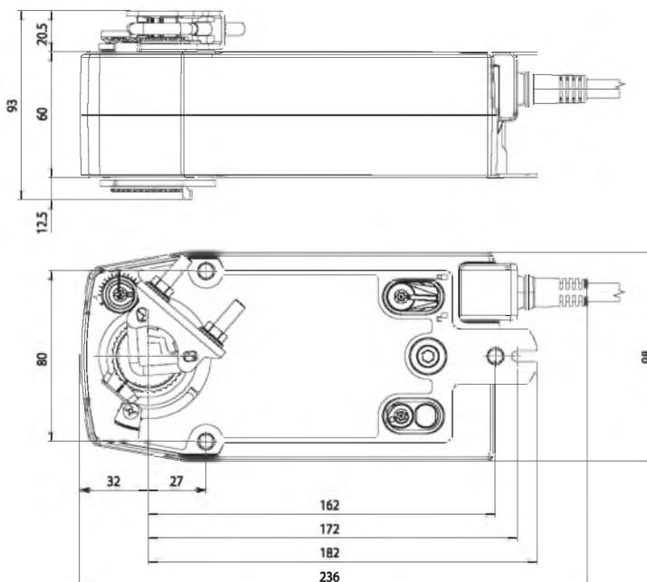
Электропривод для управления воздушными заслонками, выполняющими охраняющие функции в системах вентиляции и кондиционирования воздуха зданий
